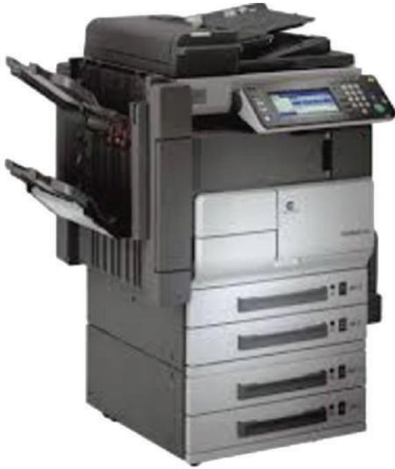
سُمّيت هذه الآلة متعددة الوظائف؛ فهي آلة تصوير، وجهاز فاكس، وماسح ضوئي، وطابعة، متّصلة بشبكة الحاسوب من خلال مدخل الشبكة، أو من خلال USB، وتستخدم هذه الآلية تقنية التصوير الكهربائي (Xerography)، إذ تعتمد آلية تصوير المستندات على الكهرباء الكهروستاتيكية، حيث تتكوّن شحنات موجبة أو سالبة على المادة لتكوّن رسوماً كهروستاتيكية على مستقبلة ضوئية حسّاسة للضوء؛ من أجل جذب جسيمات الحبر، ثم نقلها إلى الورق صورةً طبق الأصل عن الوثيقة المراد تصويرها، ثم يتمّ استخدام الحرارة، أو
