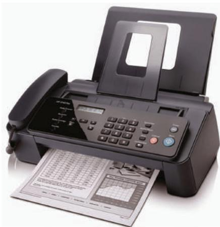
يتم إرسال النسخ الورقية المطبوعة عن طريق خط الهاتف بعد مسحها ضوئياً، وتحويلها إلى صورة نقطية يُعبّر عنها رقمياً؛ لترسل على شكل إشارات كهربائية، وعند وصولها إلى جهاز الفاكس المقابل يقوم بإعادة تحويلها بشكل عكسي، وطباعتها نسخة ورقية.
