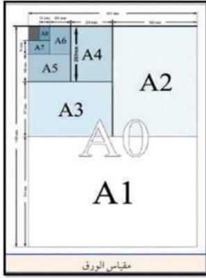
■ ورقة الرسم: ورقة بيضاء تستخدم للرسم، وهي مستطيلة الشكل ونسبة طولها إلى عرضها ثابتة دائماً .
