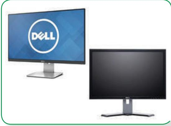
تعتبر الأكثر استخداماً بين أنواع الشاشات المختلفة، حيث تستخدم حالياً في شاشات الحواسيب المحمولة وشاشات التلفاز والساعات الرقمية والهواتف الذكية؛ وذلك عائد لسعرها المناسب وعرضها الألوان بشكل رائع عندما تكون الاضاءة جيّدة واستهلاكها القليل للطاقة، ومن عيوبها نذكر: عمرها الافتراضي القصير نسبياً، واللون الأسود ليس بدرجة العتمة المناسبة، وعدم وضوح عرض الشاشة عن بُعد أو من الجوانب. ومن أنواعها: شاشات CCFL، وشاشات LED.
