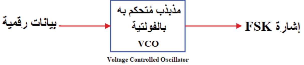
شكل (3) دائرة توليد إشارة "FSK"
