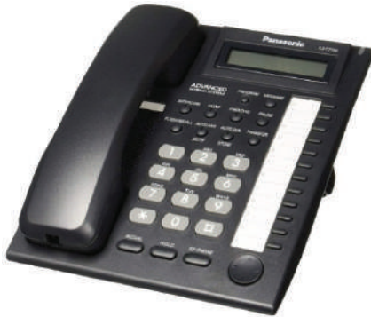
شكل (2): جهاز هاتف خاص (PT) مزود بشاشة
