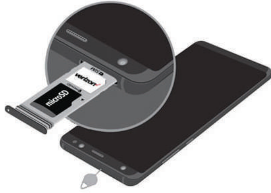
شكل (11): حاضنة لبطاقة (SIM) وذاكرة (Card SD)
